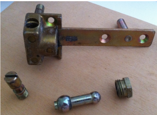
Informativ: Unteres Schwenk- Kiplager, Einzelteile
